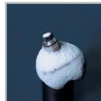
Чтобы аккуратно удалить паковочную массу с объекта литья способом пескоструйной обработки при помощи окиси алюминия, очищенные прилитые основы покрываются защитным холодным полимером. После застывания пластмассы, конструкцию можно без опасений отпескоструить.
